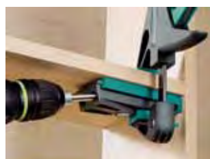
Az "Undercover Jig" készülékkel pontos furatot készít a munkadarabba...
