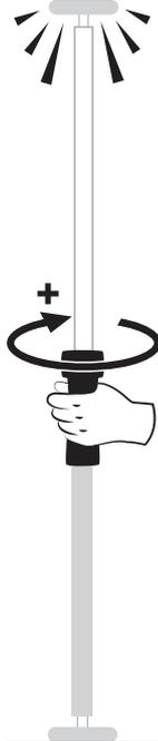
Den Griff Richtung + (siehe Zeichen im Griff) drehen, um die Spannkraft zu erhöhen (maximal 450kg).
