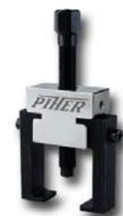
Anwendbar, wenn die Achse übereinstimmt mit der Wasserdüse des Scheibenwischers
