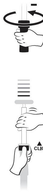
**1** Nach dem Gebrauch den Griff Richtung - (siehe Zeichen im Griff) drehen, um die Spannkraft zu reduzieren.
